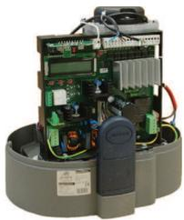
**BIG 2.2** è un motoriduttore elettromeccanico irreversibile 230 Vac per cancelli scorrevoli fino a 2200 kg di peso. Centralina CT INVERTER incorporata. Regolazione di coppia elettronico, rallentamenti in apertura e chiusura regolabili senza perdita di potenza, gestione indipendente della corsa d'apertura e di chiusura, encoder ottico, display LCD per la programmazione.
