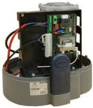
**BIG 2.2** è un motoriduttore elettromeccanico irreversibile 230 Vac per cancelli scorrevoli fino a 2200 kg di peso. Centralina BIOS1 incorporata con ricevitore radio. Regolazione di coppia elettronico, rallentamenti in apertura e chiusura regolabili, gestione indipendente della corsa d'apertura e di chiusura. Centralina con gestione di un trasmettitore tramite display.
